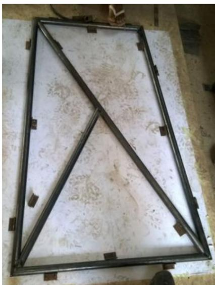
**Figura 1** - Corta fogo do veículo, que é a estrutura que separa o piloto do motor.
