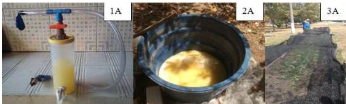
Figura 1A – protótipo do reator anaeróbio; Figura 2A – tanque com manipueira, onde ocorre o processo de fermentação mista; Figura 3A – aplicação prática de irrigação com manipueira em canteiro de alface.
