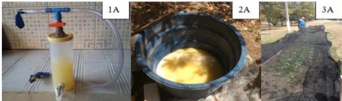
Figura 1A – protótipo do reator aeróbico; Figura 2A – tanque com maniveira, onde ocorre o processo de fermentação mista; Figura 3A – aplicação prática de irrigação com maniveira em canteiro de alface.
