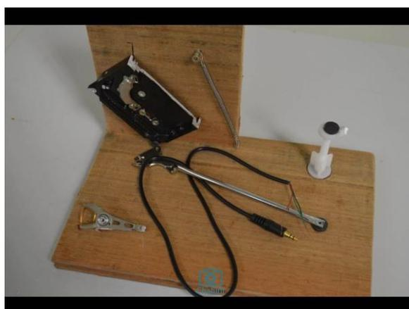
**Figura 2.** Protótipo de sismômetro desenvolvidos pelos alunos do curso de Geofísica. Fonte: acervo do projeto.
