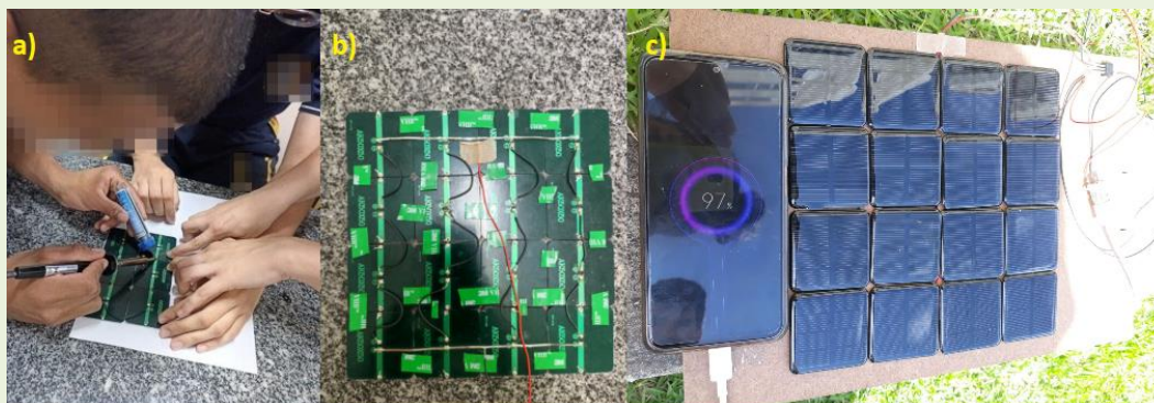
FIGURA 7 – Etapas de construção do carregador solar, sendo a) as conexões das células solares, b) a circuito finalizado e c) o carregador solar em operação
